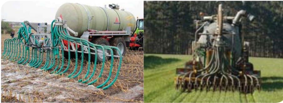
Fotografías: sistemas de tubos colgantes (izquierda) y de inyección y enterrado (derecha) para purines. Fuente: Proyecto SUBPGAN.
